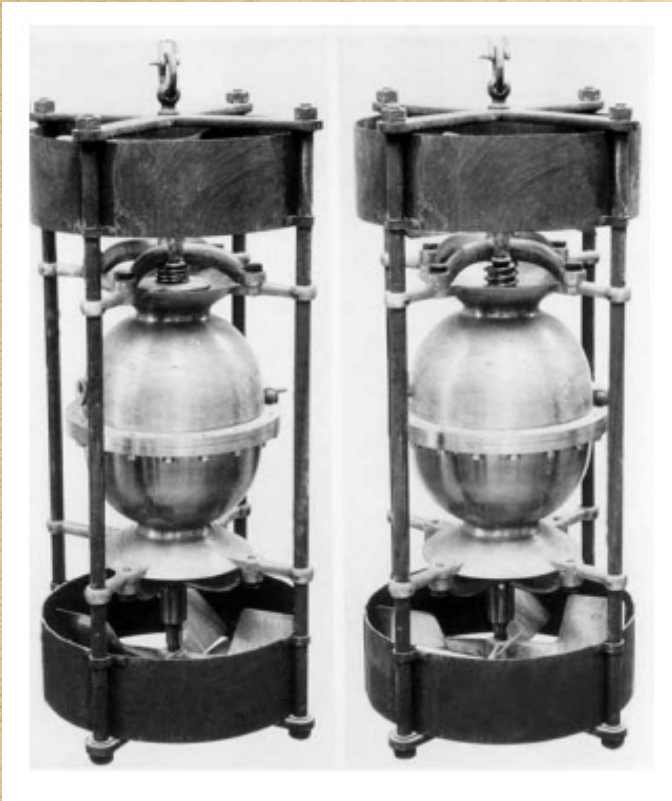
Батонометр для використання у чорноморській експедиції (1892)
